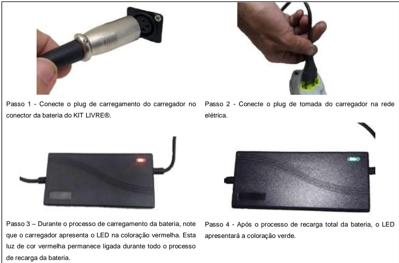
Figura 12 – Processo de recarga da bateria do KIT LIVRE®.
