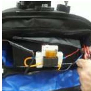
Passo 4 - Conecte os terminais da bateria nos terminais do plug do carregador da bateria.
