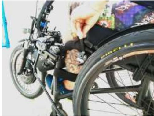
Figura 23 - Destravamento dos freios de estacionamento da cadeira de rodas – \* Imagem meramente ilustrativa.
