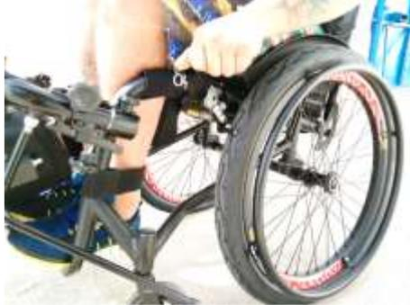
Figura 24 - Travamento dos freios de estacionamento da cadeira de rodas – \* Imagem meramente ilustrativa.
