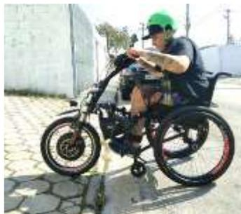
Figura 33 - Subida de calçadas com o KIT LIVRE®, posicionamento do tronco (3ª posição) – \* Imagem meramente ilustrativa.
