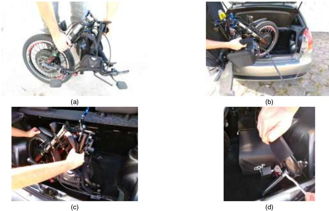
Figura 43 – Armazenamento do KIT LIVRE® no porta-malas em veículo compacto modelo Hatch: (a) KIT LIVRE® dobrado; (b) colocar no porta-malas; (c)acomodar o KIT LIVRE®; (d) afrouxar o cavalete do suporte, caso necessário e reapertar em seguida – \* Imagem meramente ilustrativa.
