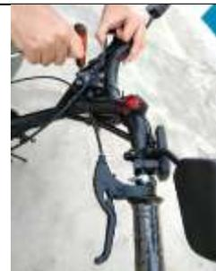
Passo 12: Caso necessário, afrouxar os parafusos M8 da coluna de direção do KIT LIVRE® e ajustar o posicionamento do guidão. Reapertá-los após o ajuste.
