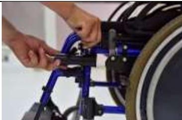
Passo 7: Instalar os parafusos(19,20) e apertar com a chave Allen 3/16”(13).
