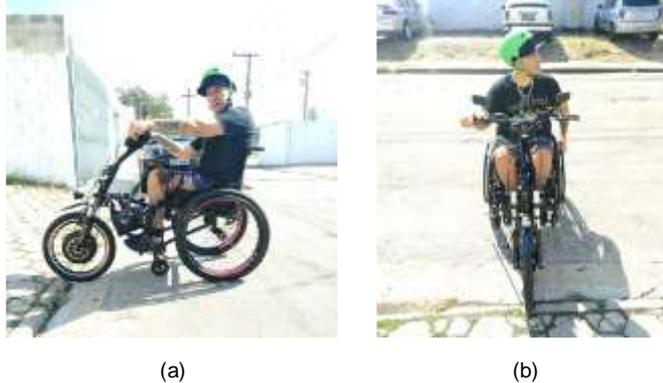
Figura 30 - Subida de calçadas com o KIT LIVRE® (1ª posição): (a) Vista lateral; (b) Vista frontal – \* Imagem meramente ilustrativa.
