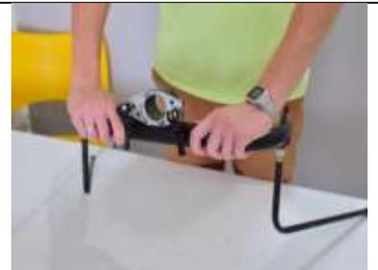
Passo 6: Posicionar o centro do suporte (8) com o acoplamento central para cima.
