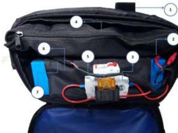
Figura 7 - Bolsa aberta com componentes eletrônicos – KIT LIVRE® Pro 1000W – \* Imagem meramente ilustrativa.
