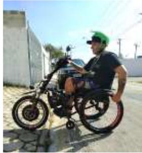
Figura 32 - Subida de calçadas com o KIT LIVRE® com auxílio de propulsão na roda traseira – \* Imagem meramente ilustrativa.
