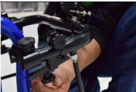
Passo 10: Apertar os manipuladores (1) de segurança na parte inferior dos acoplamentos laterais (17).
